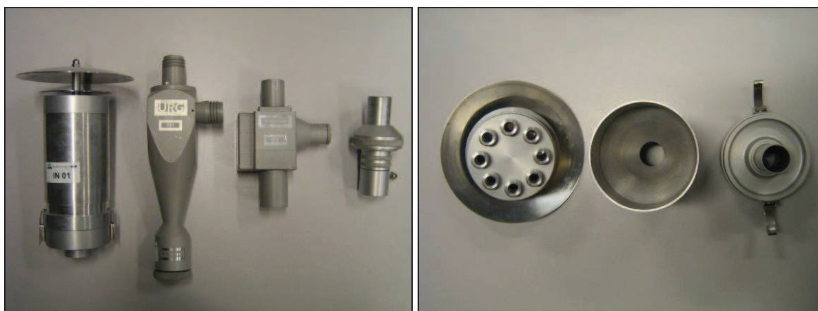
Figuur 4 Linksboven: meting van de uitgaande lucht in twee ventilatorkokers geplaatst op het biofilterbed. Aan een houten balk, in de kokers, hangen de monsternamekoppen voor PM10/PM2,5. Rechtsboven: de 'constant flow' monsternamepomp voor fijnstofbemonstering. Linksonder: monsternamekoppen voor PM10 en PM2,5 met (van links naar rechts): inlaat, PM10 cycloon, PM2,5 cycloon en filterhouder. Rechtsonder: de constructie van de inlaat.
